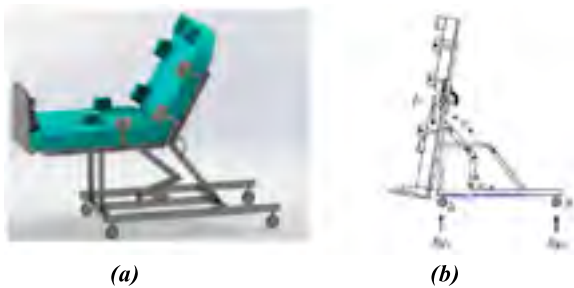
Figura 4. (a) Primer diseño del dispositivo mediante SolidWorks®, (b) diagrama de cuerpo libre de la primera propuesta.
