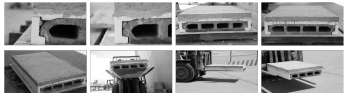
Figura 25. Prueba con las variables controladas revenimiento y tamaño del agregado del concreto.
