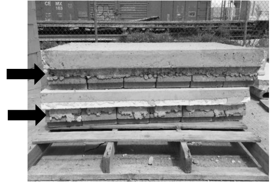
Figura 31. Comparativa de muestra de cuñas de anclaje del sistema tradicional normal (muestra de arriba) vs con diseño de placa aislante estructural (muestra de abajo).
