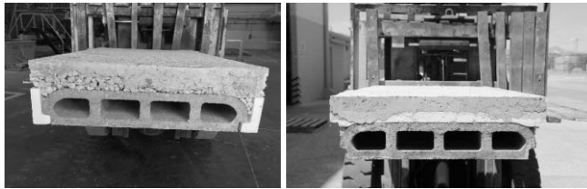
Figura 30. Comparativa de muestra de sistema tradicional (normal) vs con diseño de placa aislante estructural.
