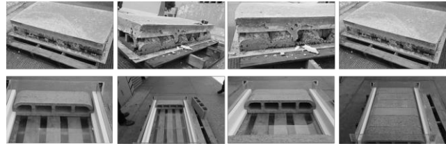
Figura 26. Prueba con el concreto solidificado (fotos superiores) y muestra de la siguiente prueba con la vigueta de prototipo de poliestireno expandido (fotos inferiores).
