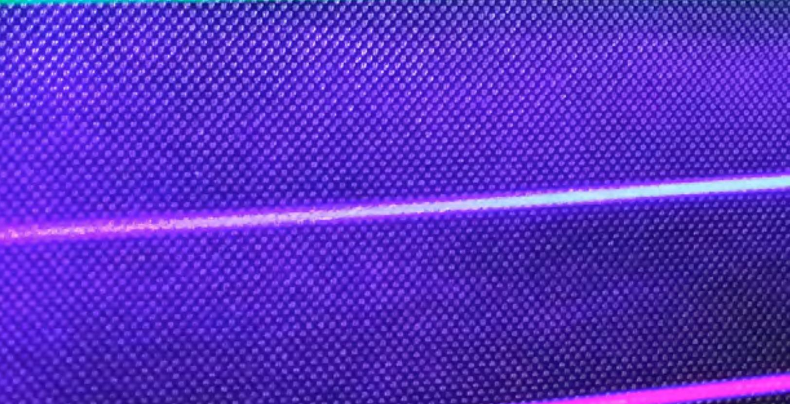
y tiene una modulación de 1280 X 1024 píxeles y un área activa de 17.43 X 13.95 mm, cada píxel tiene un tamaño de 13.62  $\mu\text{m}$ . La pantalla de cristal líquido forma parte de un dispositivo con circuitos integrados, que junto con una computadora, puede funcionar como una pantalla auxiliar, en la cual es posible proyectar imágenes y videos.
